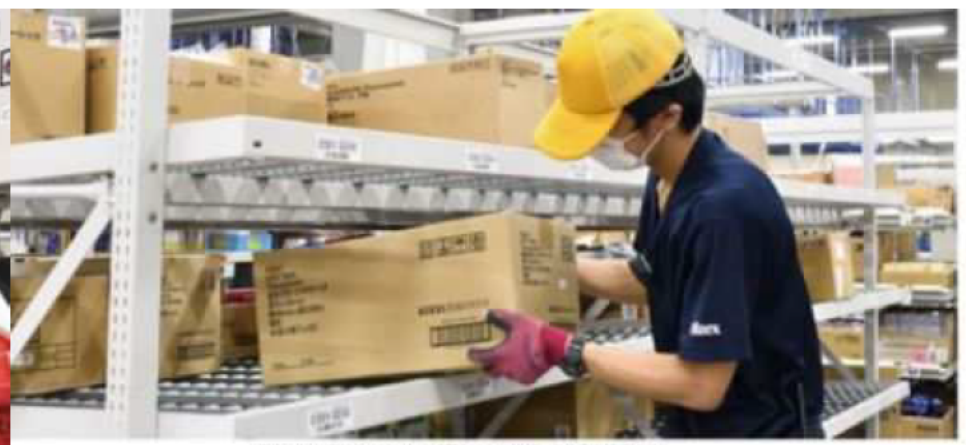
指定されたデジタルピッキング用ラックの後面から商品を補充する
